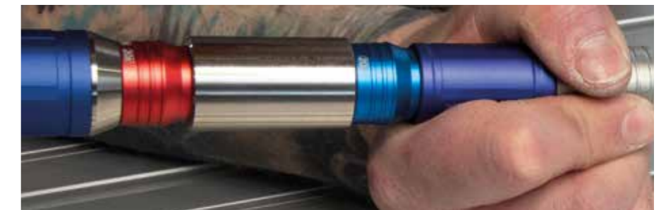
oben: Reduziergetriebe mit Handstück | unten: extra langes Handstück mit Diamant-Schleifstift
