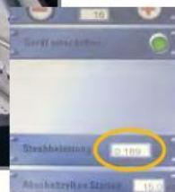
Die Anlage kann mit der speziellen Feinstaub-Messautomatik FSX ausgestattet werden. Die Staubbelastung wird permanent im Arbeitsraum gemessen und über das Display angezeigt.
