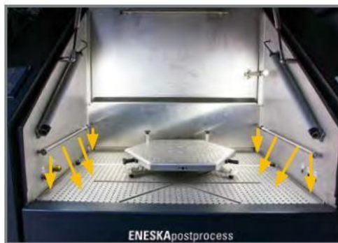
Nach dem Bearbeitungsvorgang lässt sich die Anlage erst nach einem speziellen automatischen Reinigungsprozess öffnen, bei dem Reststäube aus den Ecken des Bauraums aufgewirbelt und abgesaugt werden.
