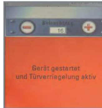
Das Arbeiten in der ENESKApostprocess ist nur bei laufender Absaugung möglich. Während des Bearbeitungsvorgangs ist die Anlage verschlossen.
