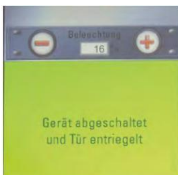
Erst nach erfolgtem Abreinigungsprozess entriegelt die Anlage und der Arbeitsraum wird frei gegeben.
