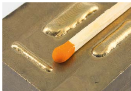
Aufbau-Schweißnaht - Material Bronze
