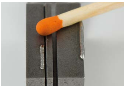
Aufbau-Schweißnaht - Material Stahl
