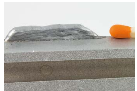
Aufbau-Schweißnaht - Material Aluminium
